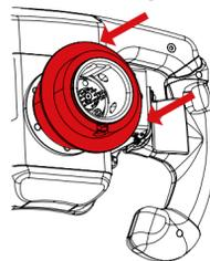
Schieben Sie das F1® Lenkrad (H) auf die CSL Elite Wheel Base (A) Achse.
