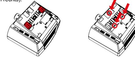
**WICHTIG:** Verwenden Sie nur hochwertige M6-Schrauben. Wählen Sie die richtige Schraubenlänge, damit das Gewinde nicht mehr als 16 mm in den Radstand hineinragt. **Beispiel: Wenn Ihr Tisch 20 mm dick ist, darf die Schraube eine Gesamtlänge von 36 mm nicht überschreiten!** Verwenden Sie immer alle drei Fixpunkte, da dies eine korrekte und stabile Installation ermöglicht und Beschädigungen verhindert!
