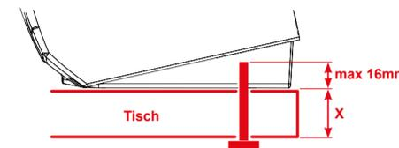
**HINWEIS:** Um den CSL Elite Wheel Base + mit Schrauben an einem Tisch oder System zu befestigen, finden Sie die druckbare Bohrvorlage im Downloadbereich unserer Website: [www.fanatec.com](http://www.fanatec.com)
