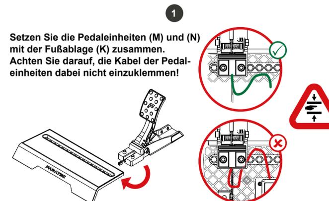
1. Setzen Sie die Pedaleinheiten (M) und (N) mit der Fußablage (K) zusammen. Achten Sie darauf, die Kabel der Pedaleinheiten dabei nicht einzuklemmen!
