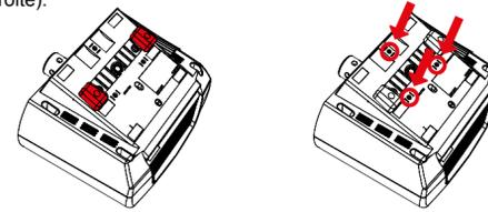
**IMPORTANT:** Utilisez uniquement des boulons M6 de bonne qualité. Choisissez la bonne longueur de boulon pour empêcher le filetage d'atteindre plus de 16 mm dans l'empattement. **Exemple: Si votre table a une épaisseur de 20 mm, les boulons ne doivent pas dépasser une longueur totale de filetage de 36 mm!** Utilisez toujours les trois points de fixation rigides car cela permet une installation correcte et stable et évite les dommages!
