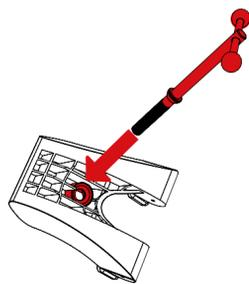
2 Tourner la vis de serrage (C) dans la partie inférieure centrale de la base CSL Elite (A).
