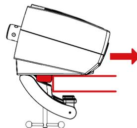
4 Fixez et verrouillez la pince de fixation (B) à l'aide de la vis de fixation (C). Veillez en même temps à l'alignement des pieds de la pince de fixation. Ceux-ci doivent se trouver bien à plat sur la surface de la table.
