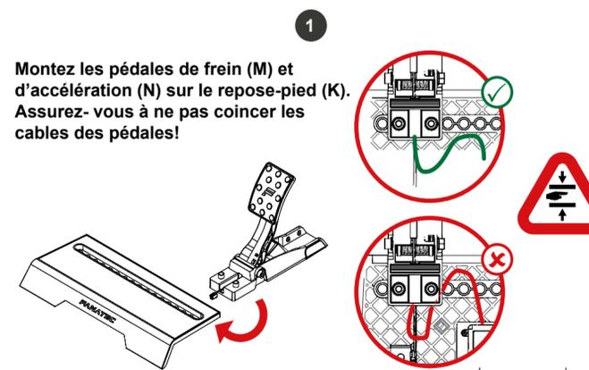
1 Montez les pédales de frein (M) et d'accélération (N) sur le repose-pied (K). Assurez-vous à ne pas coincer les câbles des pédales!
