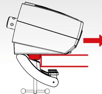
Fixez et verrouillez la pince de fixation (B) à l'aide de la vis de fixation (C). Veillez en même temps à l'alignement des pieds de la pince de fixation. Ceux-ci doivent se trouver bien à plat sur la surface de la table.
