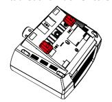
WICHTIG: Verwenden Sie nur hochwertige M6-Schrauben. Wählen Sie die richtige Schraubenlänge, damit das Gewinde nicht mehr als 16 mm in den Radstand hineinragt. Beispiel: Wenn Ihr Tisch 20 mm dick ist, darf die Schraube eine Gesamtgewindelänge von 36 mm nicht überschreiten Verwenden Sie immer alle drei Fixpunkte, da dies eine korrekte und stabile Installation ermöglicht und Beschädigungen verhindert!
