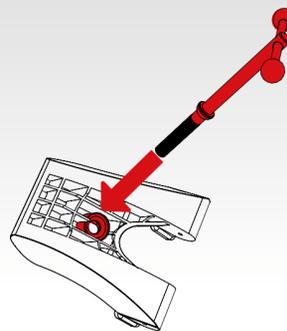
Tourner la vis de serrage (C) dans la partie inférieure centrale de la base CSL Elite (A).
