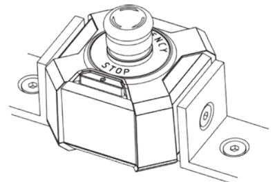
Les plaques filetées M6 sur le Podium Kill Switch permettent diverses méthodes de montage.
