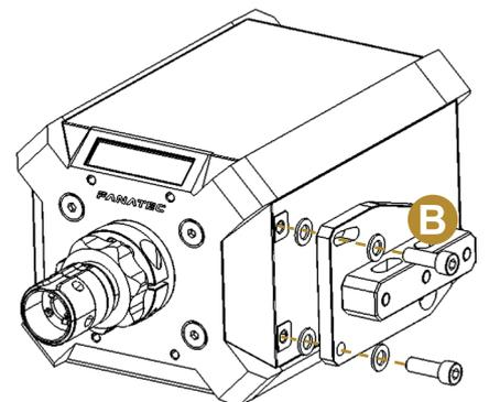
4つの取り付けアームを取り付けプレートにねじ込みます。取り付けアームを、角度の付いた側を正面に、取り付けプレートの上部と底部に取り付けます。
